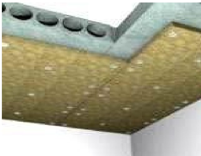
Рисунок 3.13 – Приклад утеплення перекриття зі сторони підвалу
