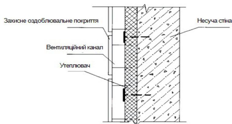
Рисунок 3.12 – Утеплення стін за методом «керамічний вентильований фасад»
