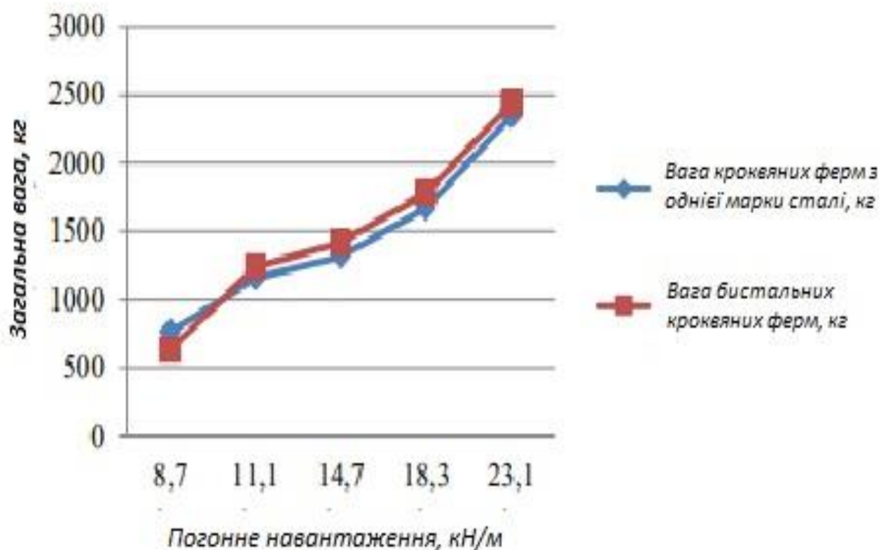
Рисунок 3.27 - Залежність металоємності кроквяної ферми від навантаження для прольоту 30 м при кроці 6 м
