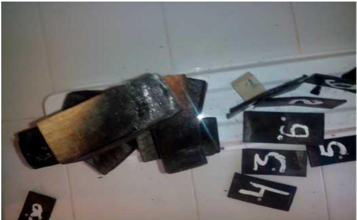
Рисунок 3.10 - Зразки, що показали найменші та найбільші значення руйнування деревини та міцності металевих пластин на вигин
