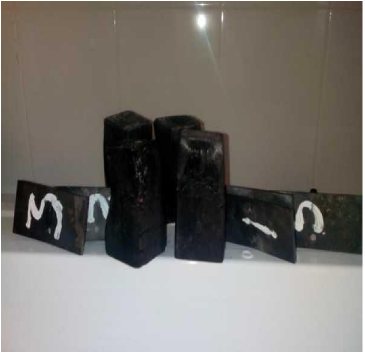
Рисунок 3.8 - Результати впливу відкритого полум'я протягом 10 та 25 хвилин на проби зразка №5 необробленого вогнезахисними засобами
