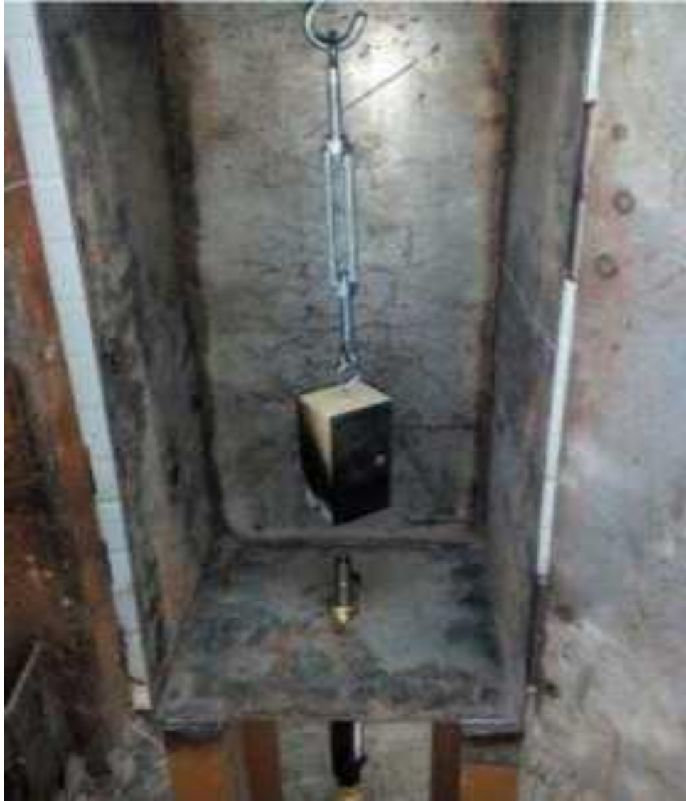
Рисунок 3.3 - Розташування зразка в приладі визначення вогнестійкості модифікації ОТ – 68
