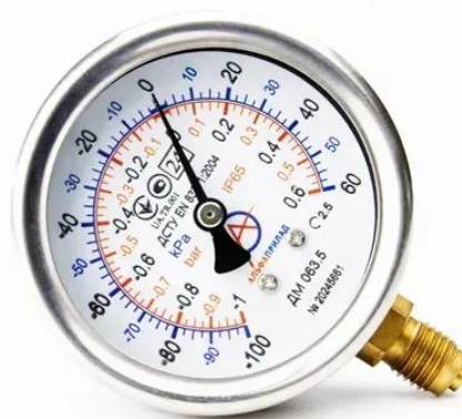
Рисунок 4.4 – Зовнішній вид манометра ДМ-100 [22]
