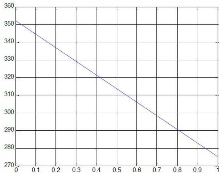
Рисунок 3.2 – Статична характеристика конденсатора за каналом «витрата води – температура охолодженої суміші»
