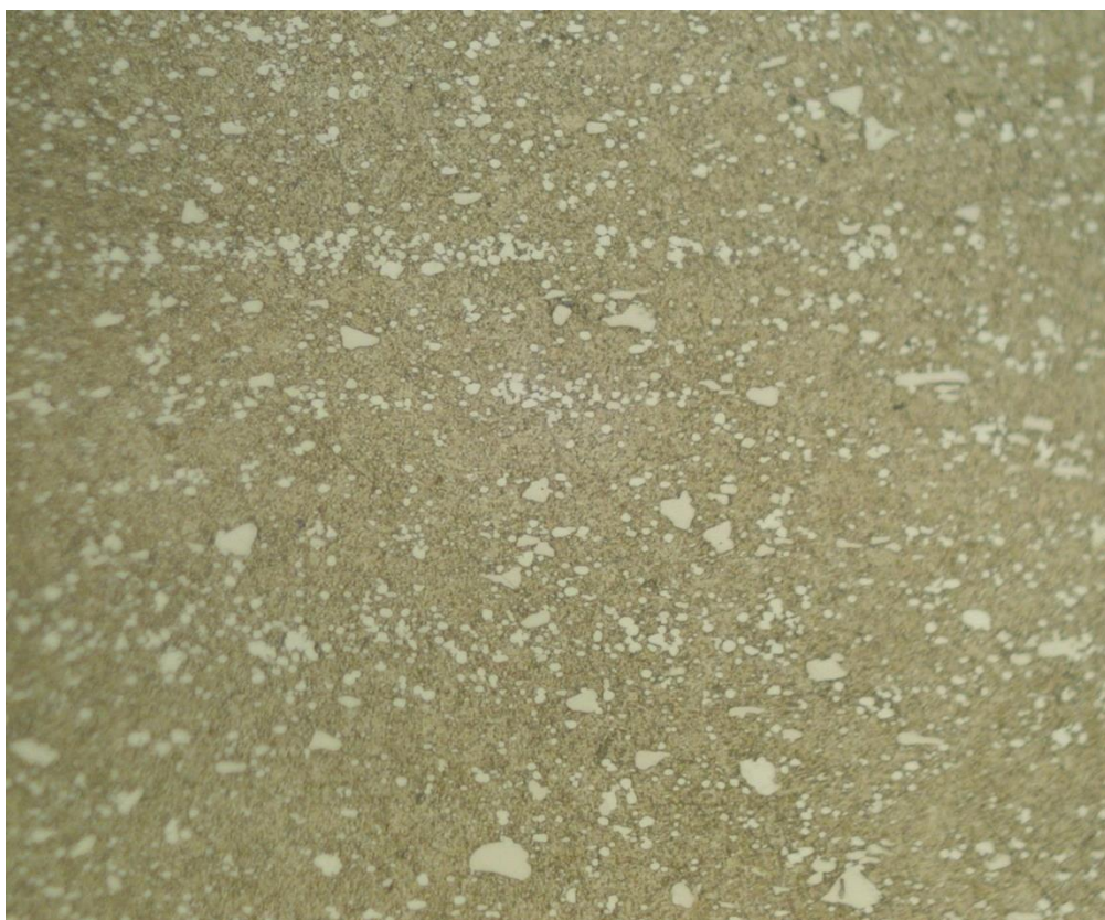
Рисунок 5 - Рядкова спрямованість карбідів у порошковій сталі (X300)
