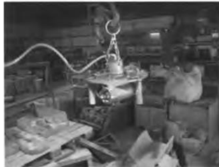
Рисунок 13 - Механізоване набивання футерування тигля індукційної печі HFD-4 СПО ЦПМ
