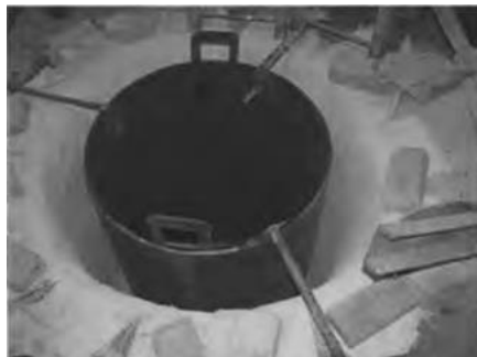
Рисунок 11 - Загальний вигляд індукційної печі HFD-4 СПО ЦПМ із закріпленим металевим шаблоном перед набиванням футерування
