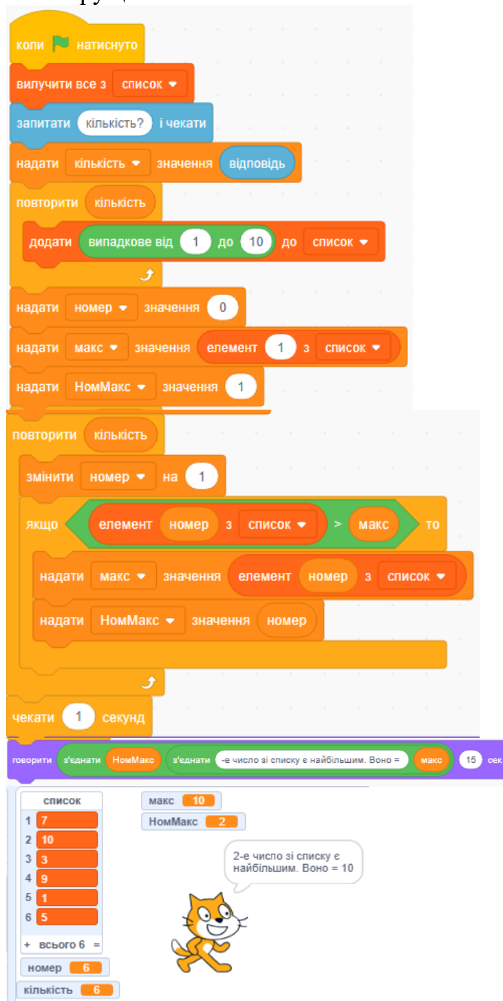
Рис. 4.9 – Код та блок-схема програми пошуку найбільшого елемента списку та його номера
