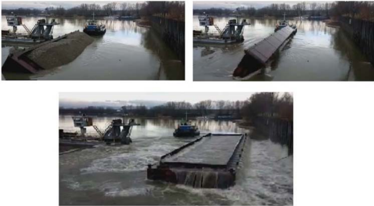
Рисунок 3.5 – Послідовність розвантаження баржи-понтона, що перевертається
