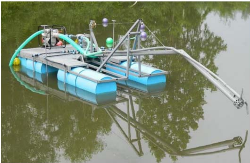
Рисунок 3.2 – Транспортування ґрунту землесосними снарядами
