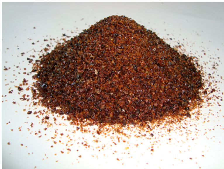
Рис. 2.1. Загальний вигляд зварювального плавленого флюсу
