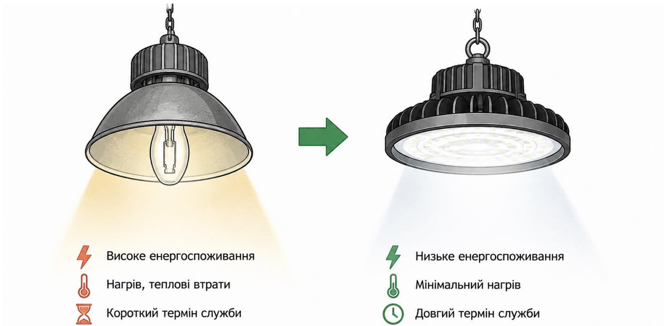
Рисунок 3.1 — Схема технічного переоснащення системи освітлення (а — базова лампа, б — енергозберігаюча)
