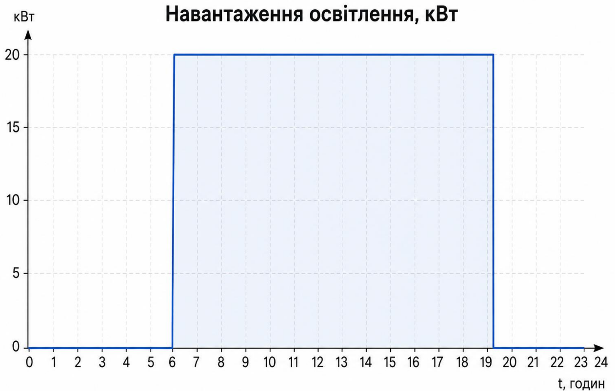
Рисунок 2.1 — Добовий графік навантаження освітлювальних установок
